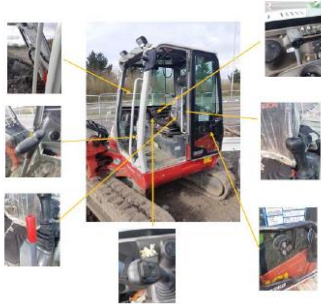
Contact Points in a Mini Digger
